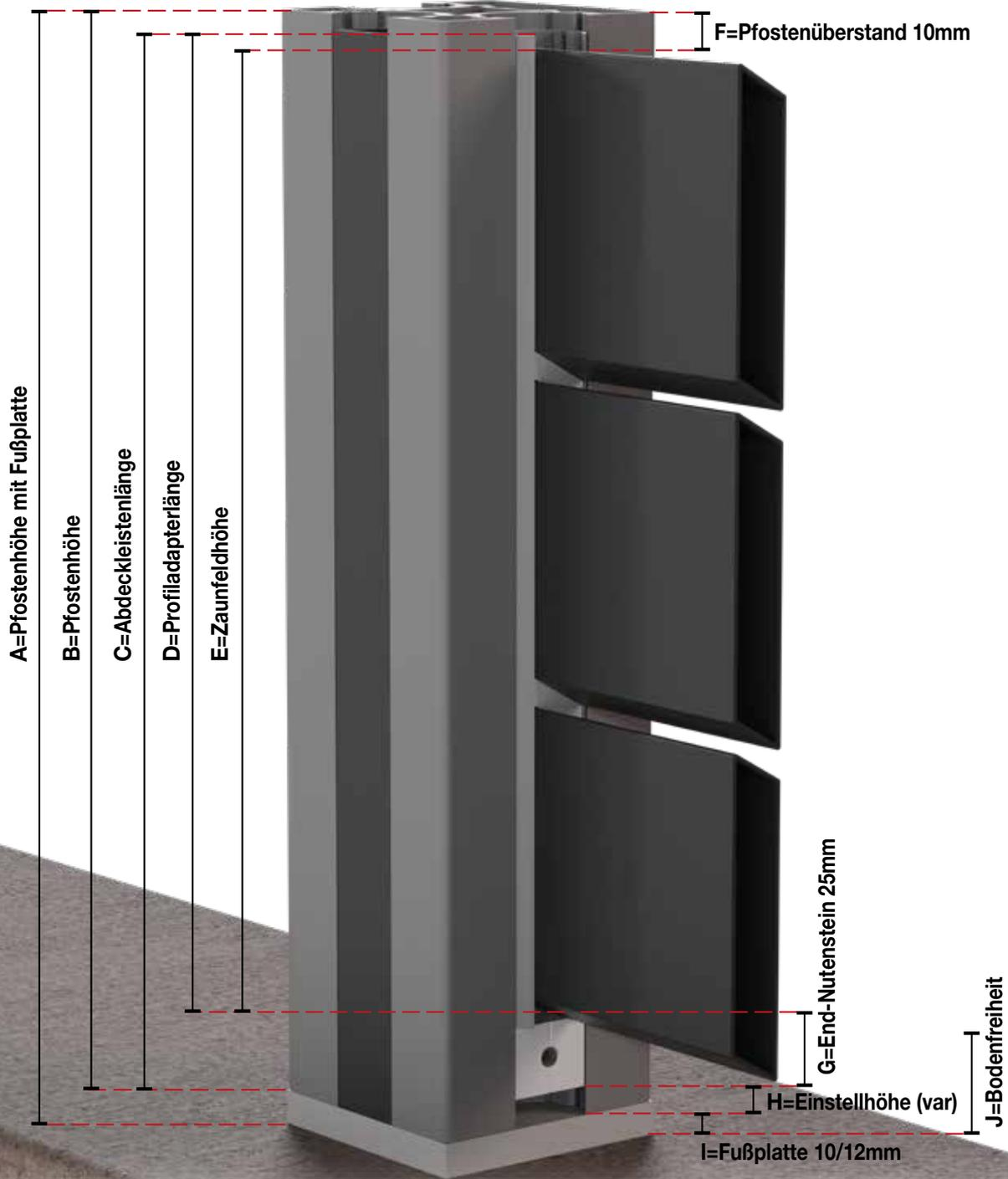
\* Ideale Werte. Aufgrund von Bauteiltoleranzen, Umgebungstemperatur und Genauigkeit beim Aufbau ist es eventuell nötig, die Maße bauseits im Millimeterbereich anzupassen.
