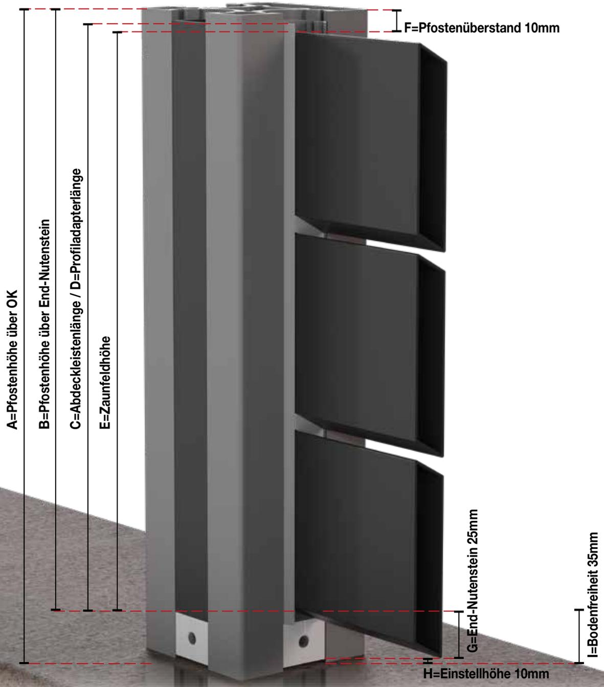
\* Ideale Werte. Aufgrund von Bauteiltoleranzen, Umgebungstemperatur und Genauigkeit beim Aufbau ist es eventuell nötig, die Maße bauteils im Millimeterbereich anzupassen.
